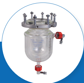
Typ(e) 1I Jacketed glass reactor, with insulation jacket ジャケット付きガラスリアクター 断熱ジャケット付き (トリプルジャケット) 0.5, 1.0, 1.6, 2.0 l 12 bar / 200°C 対応機種：ecoclave, polyclave
