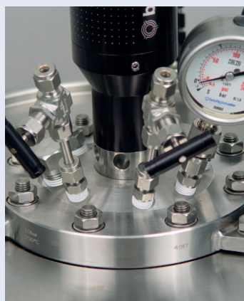
Cover plate with 7 openings カバープレート上の7ポート
