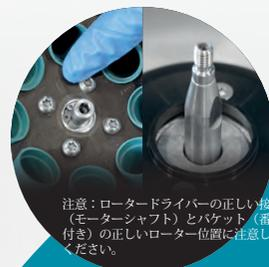
注意：ロータードライバーの正しい接続（モーターシャフト）とバケット（番号付き）の正しいローター位置に注意してください。
