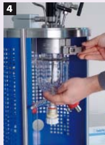
クイックアクションクローザーを閉めます。 Close quick action closure
