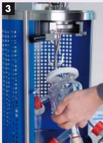
新しい容器を装着します Insert new vessel
