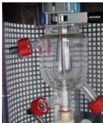
ドレンバルブ付きガラス容器 Glass vessel with drain valve
