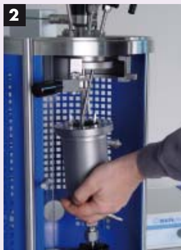
容器を外します Remove vessel
