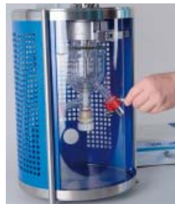
ポリカーボネート製安全カバー Polycarbonate protection screen
