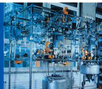
Combination: Pressure reactor with glass overhead コンビネーション：圧力容器とガラス オーバーヘッド
