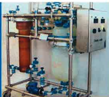
UV-reactor with brown stained glass 茶色ステンドグラス付UNリアクター
