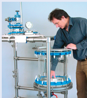
Swing-out mechanism for removal of filter cake フィルターケーキ取出し時の スイングアウト機構
