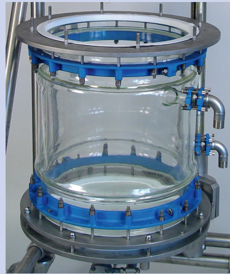
Heating / Cooling jacket 過熱 / 冷却ジャケット
