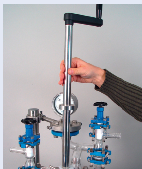
Height adjustable stirrer for optimal loosening, pressing and flattening of filter cake 高さ調整可能なスターラーはフィルターケーキの攪拌、圧縮、均一化に最適
