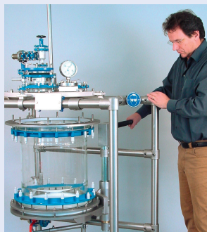
2-step lowering device 昇降機能 (2ステップ)
