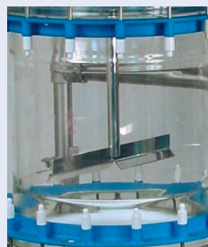
Height adjustable stirrer for optimal loosening, pressing and flattening of filter cake 高さ調整可能なスターラーはフィルターケーキの攪拌、圧縮、均一化に最適
