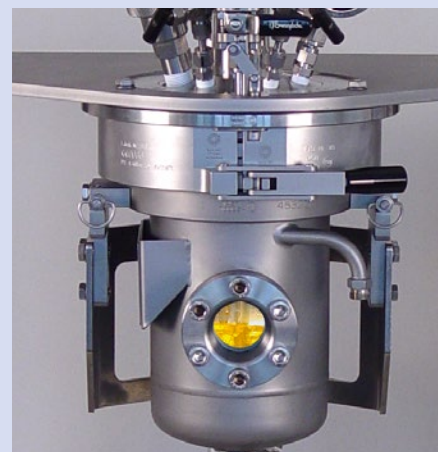
Sight glass on 60 bar pressure vessel / サイトグラス付き60bar圧力反応ベッセル
