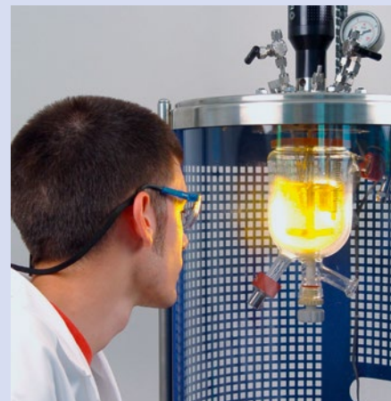
Hydrogenation in glass pressure reactor / 水素添加用ガラス製圧力反応リアクター
