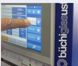
Setting of leak test parameters / リークテストパラメータの設定
