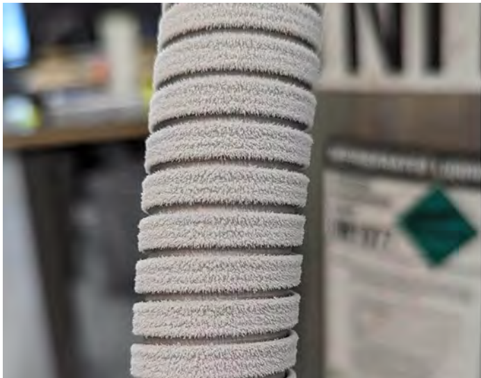
一般的な極低温ホース(真空断熱なし)
